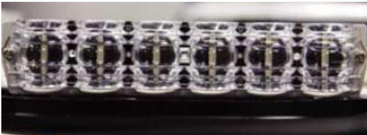
6er-LED Modul bei den 4 Aussenmodulen
