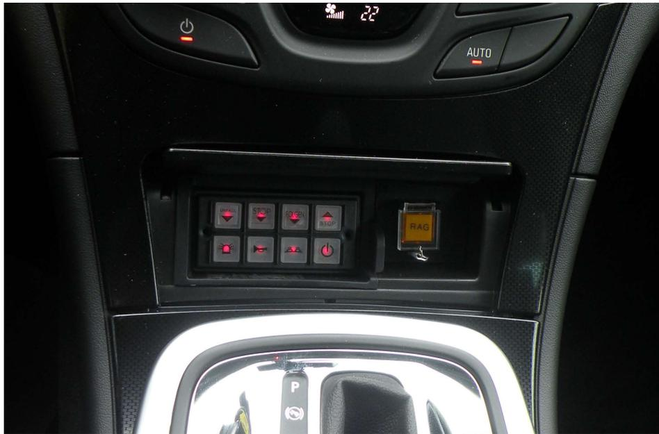
Platz gibt es meist wenig in modernen Einsatzfahrzeugen. Die Lösung: TiNY8 durch seine kompakte Bauweise lässt sich das Bedienteil fast überall einbauen.
