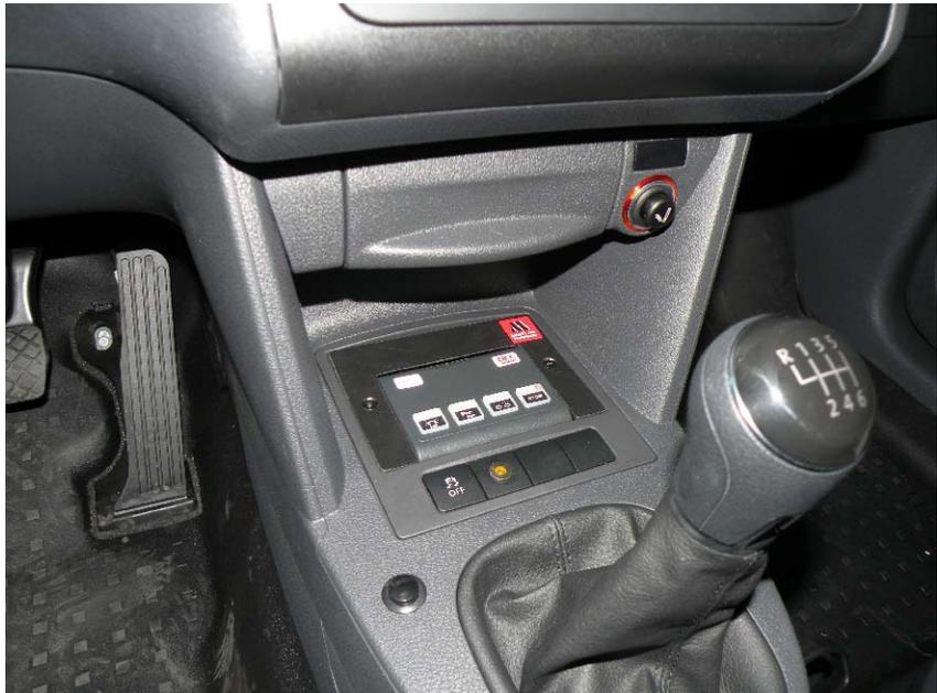
Das programmierbare Canbus-System ist die neueste Generation von Bedieneinheiten, welche über eine PC-Schnittstelle frei programmiert werden kann. Bis zu 50 Stück statisch gesicherte Ausgänge. Die Tastatur hat eine Hintergrund- und Funktionsbeleuchtung, die Symbole können frei gewählt werden (mit 64 mitgelieferten Tasten-Piktogrammen).
